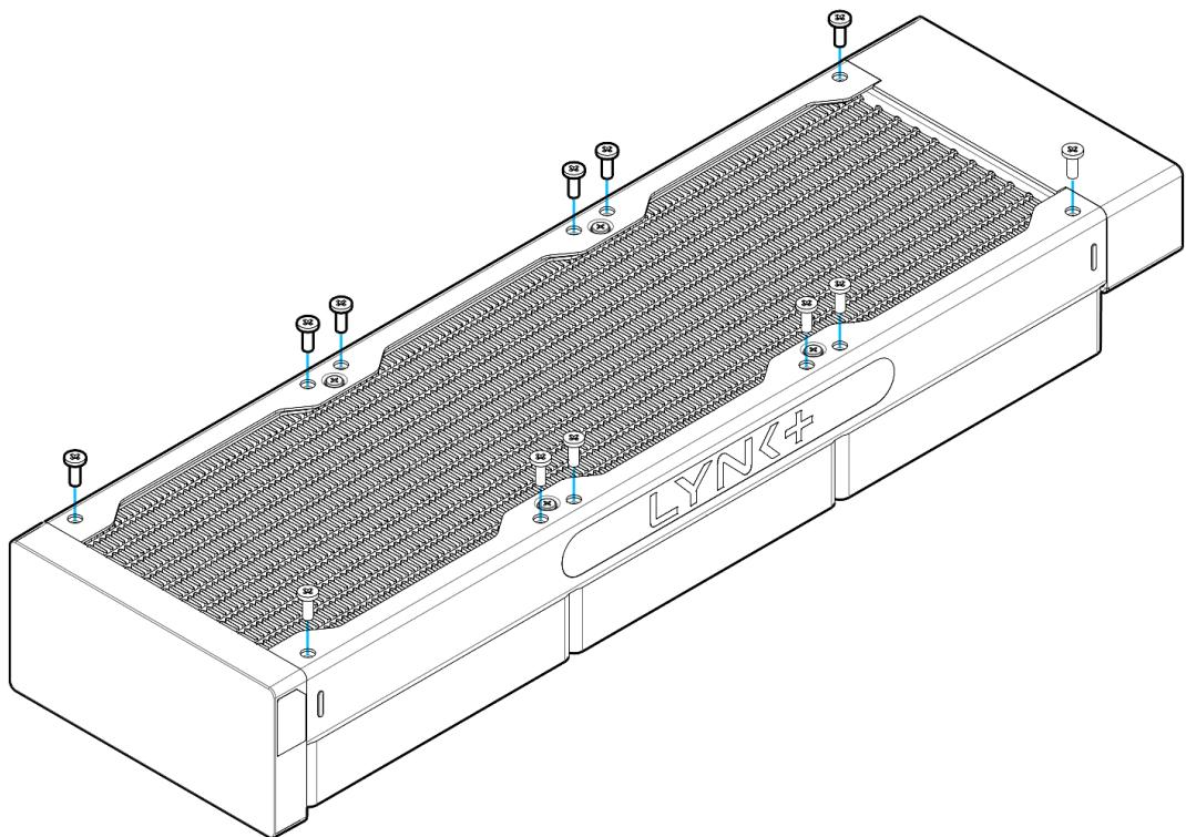
Il sistema LYNK+ permette di installare il Modulo Radiatore in qualsiasi orientazione, scegli quello che si adatta meglio alla tua case PC e monta il radiatore usando le viti fornite per il case PC.
