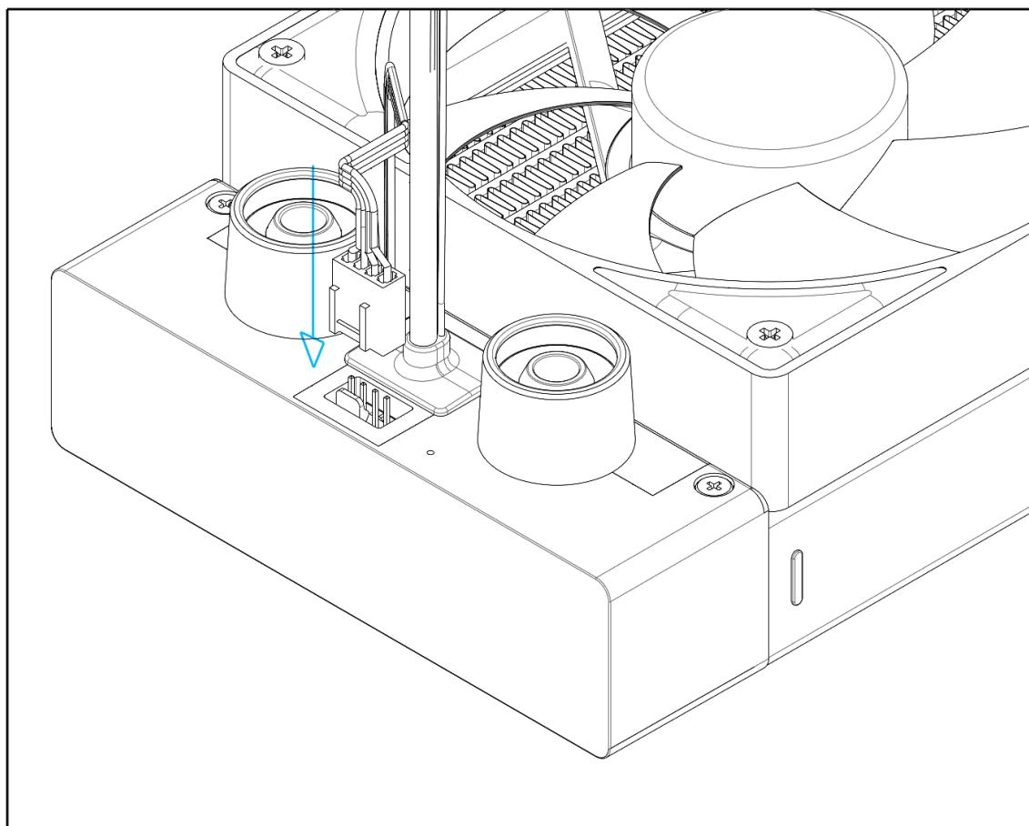
Collega tutte e 3 le ventole in margherita usando cavi a Y, e la prima al connettore PWM 4-Pin anteriore del radiatore tra i tubi. Il Radiatore fornisce potenza e autonomia ai motori alle ventole collegate.
